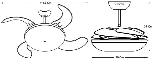
Un ventilador retráctil que genera una doble visión. Cuatro aspas diseñadas cuidadosamente para retraerse y desaparecer sobre el cuerpo de elegantes curvas de la lámpara cuando está parado, por lo que se lee como una lámpara cuando la función del ventilador no se está utilizando. Incorpora un imponente kit de iluminación con una lámpara circular de T5 40W arrancada por un balasto electrónico. Mando a distancia para control de 3 velocidades, apagado y encendido de la luz.
